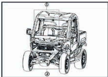
① Hovedlys ② Retningslys foran; midtstilling etter bruk.
